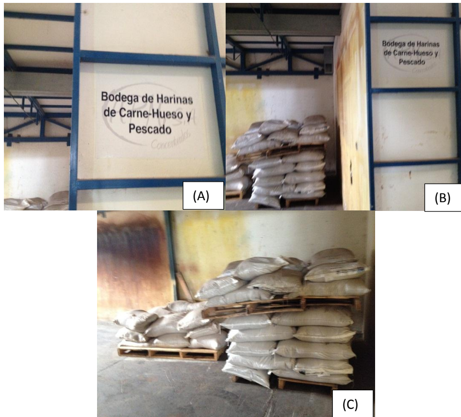
Figura.12 Ejemplos de los resultados encontrados en la inspección de almacenamiento de productos de acceso restringido. A) Área exclusiva de almacenamiento con correcta rotulación. B) Almacenamiento incorrecto de productos de acceso restringido. C) Estibaje inadecuado de sacos.
