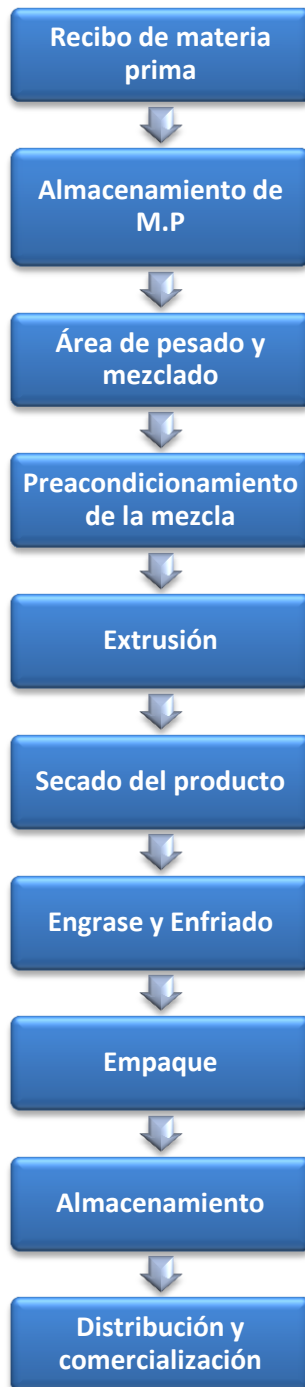
Figura 2. Diagrama de Flujo de Producción de Concentrados APM S.A Alajuela, Costa Rica. 2013. Adaptado de Concentrados APM S.A
