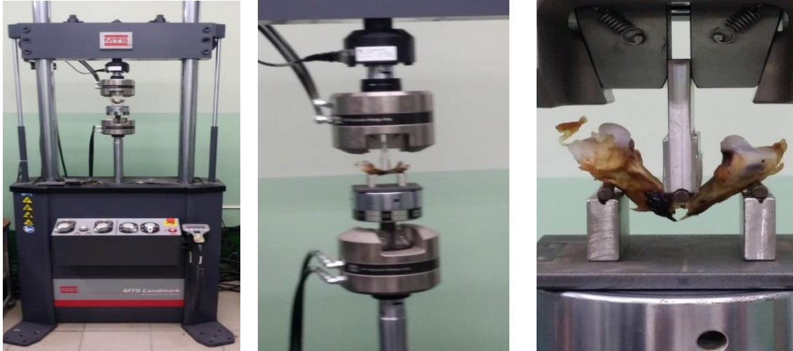
Figura 6. Proceso de la colocación de los huesos en la MTS Landmark.
