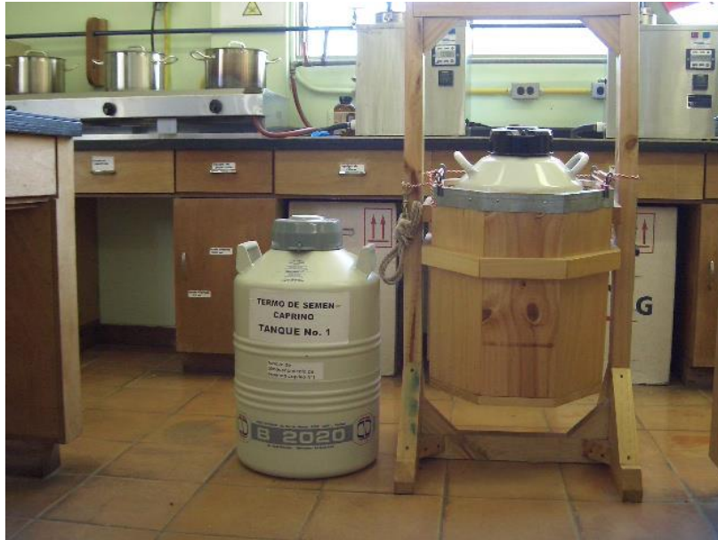
Figura 49. Tanque de nitrógeno líquido. Ochomogo, 2008.
