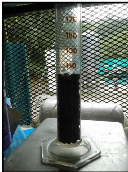
Figura 7. Prueba de densidad aparente del alimento.
