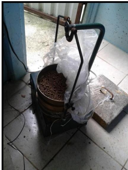
Figura 4. Equipo utilizado en la prueba de porcentaje de finos en el alimento.
