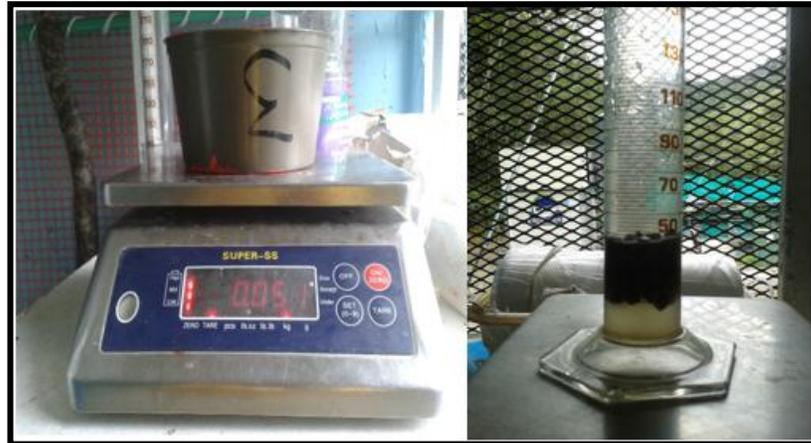
Figura 5. Equipo utilizado en la prueba de densidad.
