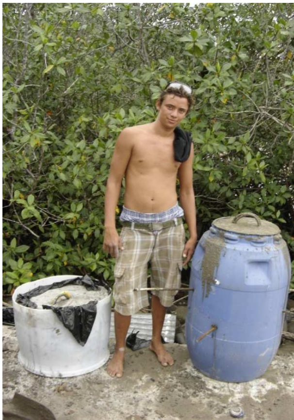
Figura 2. Ejemplo de fondos o anclajes de estañones rellenos de concreto para sujetar las jaulas. Nótese las manillas y las varillas de hierro que se colocaron para mejorar el agarre del fondo al piso del mar.
