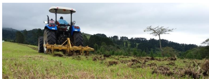
Figura 21. Utilización del renovador de potreros en el lote de corte La viuda.
