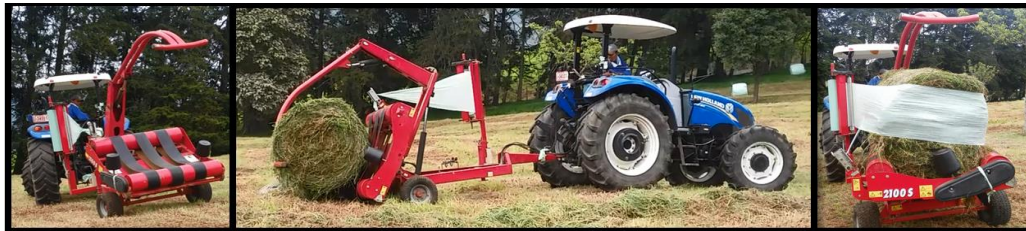
Figura 26. Emplastificadora de silopacas
