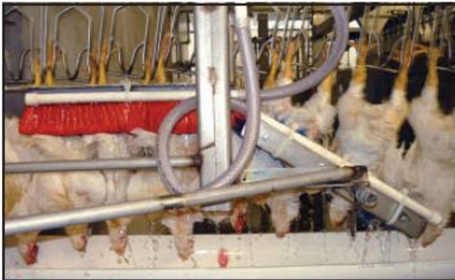
Figura 11. Sistema de lavado y cepillado para eliminar heces previamente al escaldado. Cervantes 2012.
