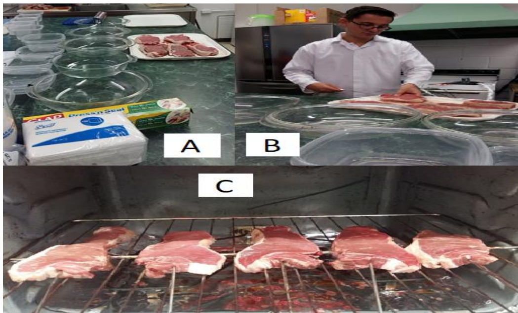
Figura 5. Pírex rotulados para recibir cada muestra (A); Colocación de las termocuplas en el sector central de cada pieza tanto de ancho como su largo (B); Se colocó los lomos en horno eléctrico, la muestra de carne a 15 centímetros por debajo de la resistencia (C).
